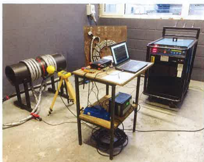
Inductieverhitting van pijp (A)
