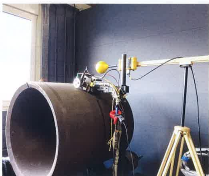
Inductieverhitting van roterende pijp (C)
